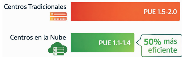
Figura 2. Comparación de Power Usage Effectiveness (PUE): centros de datos tradicionales (1.5-2.0) versus centros de datos en la nube (1.1-1.4). Fuente: Infografía de elaboración propia con apoyo de IA basada en Lawrence Berkeley National Laboratory.
