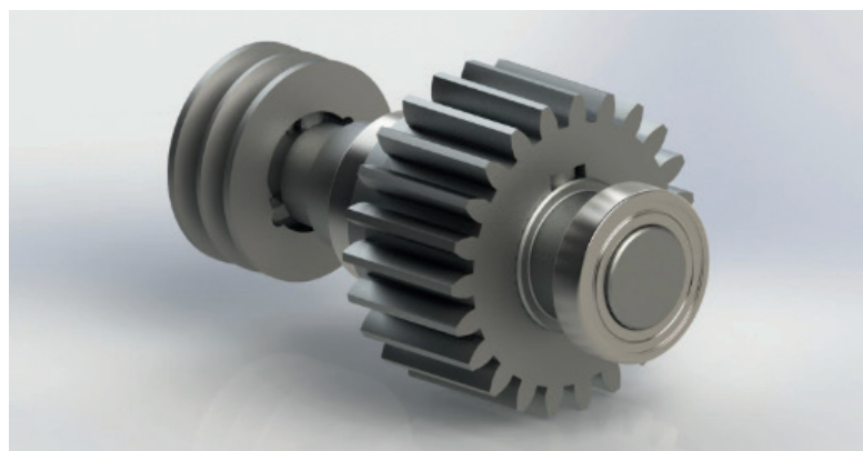
Figura 4. Diseño final de la flecha armada. Sus componentes: la polea, el engrane (o piñón), y los rodillos. Juntos forman el sistema que recibe el movimiento del motor y lo transmite de manera controlada hacia el tren de engranes. Los rodillos permiten que todo gire suavemente y sin fricción excesiva. Modelado 3D. Elaboración propia.
