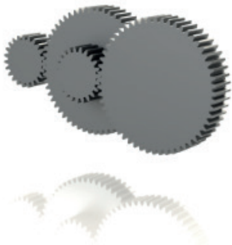
Figura 1. Engranajes conectados. En la imagen se observan cuatro engranajes conectados entre sí. Su función es transmitir el movimiento desde la polea hacia la siguiente parte del sistema, reduciendo la velocidad en el proceso. Primero, el engrane pequeño mueve al engrane grande; la cara de este engrane grande está unida a otro engrane pequeño, que a su vez transmite el movimiento a un último engrane grande. De esta manera, se consigue una reducción progresiva de la velocidad. Modelado tridimensional. Elaboración propia.
