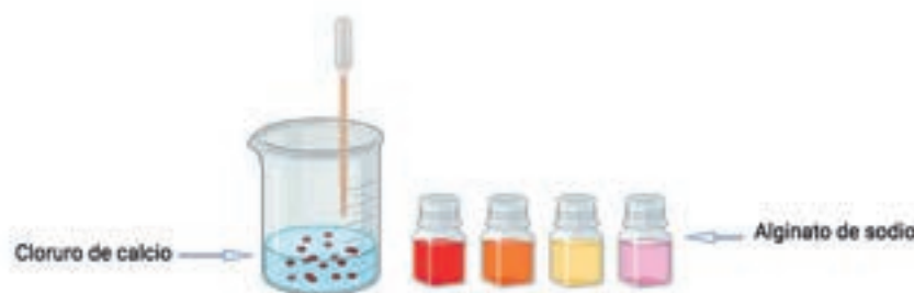
Figura 1. Proceso para la elaboración de gel de alginato de calcio.
