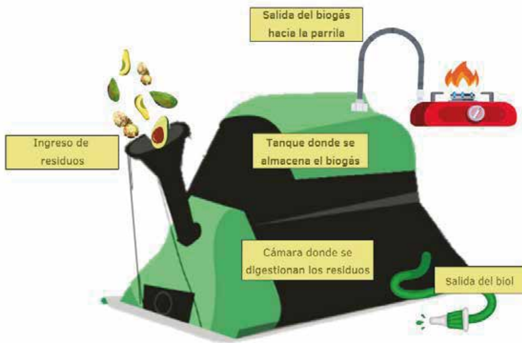
Figura 3. Biodigestor tipo bolsa. Fuente: Elaboración propia
