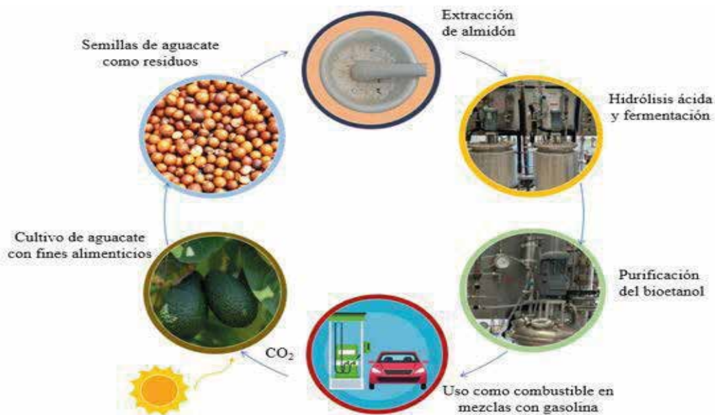
Fig. 4. Proceso general propuesto para la obtención de bioetanol a partir de la semilla de aguacate. En la planta piloto se procesaron 6 kg de almidón y fue tratado con ácido para producir glucosa, la cual fue fermentada por levaduras Saccharomyces cerevisiae para obtener 2.5 litros de bioetanol. Imagen elaborada con: www.123rf.com
