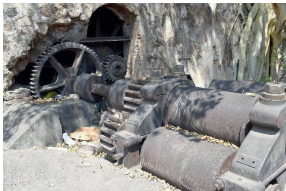
Figura 2.- Fotografía de vestigio de prensa (trapiche) para exprimir caña de azúcar, de tres mazas horizontales de hierro impulsado por fuerza hidráulica del siglo XIX, Chupio, Tacámbaro, Michoacán. Fuente: Autoría propia.
