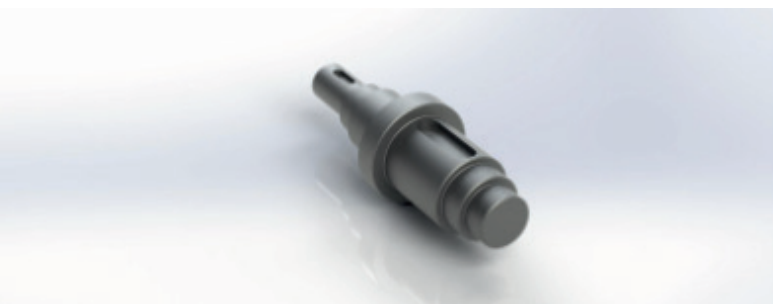
Figura 3. Diseño final de flecha. Es un eje cilíndrico sobre el cual se montan distintos componentes (como engranes o poleas). Se diseñó con diferentes diámetros en cada sección, lo que facilita que cada pieza encaje correctamente y se mantenga firme. También incluye ranuras para chavetas, pequeños elementos que ayudan a fijar los componentes y evitar que se deslicen. Modelado tridimensional. Elaboración propia.
