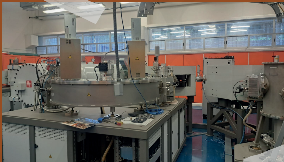
Figura 1. Este es un acelerador utilizado para realizar dataciones, pertenece al Laboratorio Nacional de Espectrometría de Masas con Aceleradores del Instituto de Física de la UNAM y se encuentra en la Ciudad de México.
