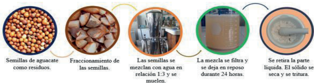
Fig. 3. Proceso de obtención de almidón a partir de la semilla de aguacate. En el laboratorio se utilizaron 20 kg de semillas de aguacate tipo Hass para obtener 6 kg de almidón como materia prima para ser procesada en planta piloto. Imagen: elaboración propia.
