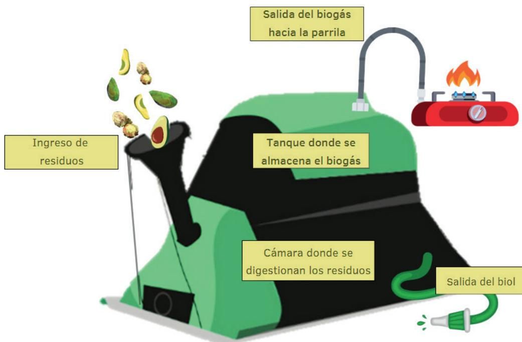
Figura 3. Biodigestor tipo bolsa. Fuente: Elaboración propia
